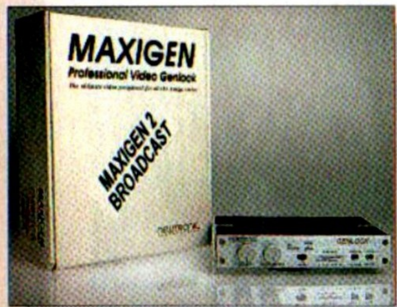
MAXIGEN. Genlock Broadcast VIIS e S-VIIS, regolazione del livello di saturazione in ingresso, Superimpose, FADE professionale, Invert Key, porta RGB passante, Croma Key, nove regolazioni accessibili esternamente. Banda passante 5,7 Mhz - 3Db.
